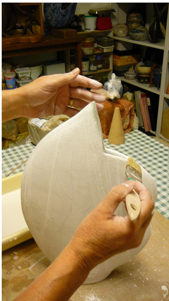
fig. 32 - applicazione leggero strato di cristallina prima della seconda cottura
